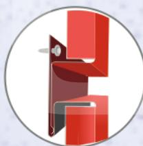
СТЫК ФАСАДНЫХ КАССЕТ (ПАНЕЛЕЙ)
