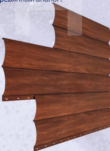
Профнастил представляет собой профилированные листы из оцинкованной стали и из оцинкованной стали с полимерным покрытием. Профнастил от С8 до Н75 производится по индивидуальному заказу клиента толщиной от 0,3 до 0,9 мм и длиной до 15 метров.
