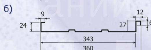
ребра жесткости на поверхности фальца
